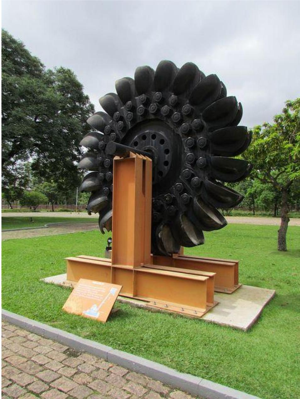
Turbina Pelton usada em Cubatão entre 1926 e 1975
